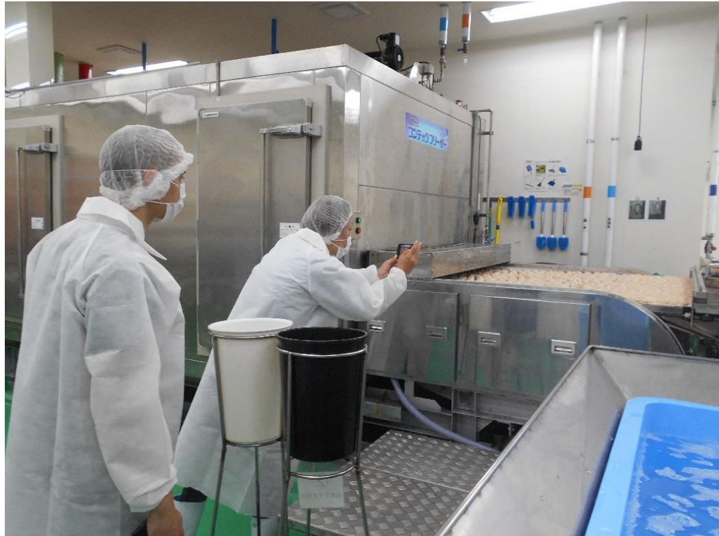
スティールベルトブリーザーで急速凍結されるホタテ貝柱
